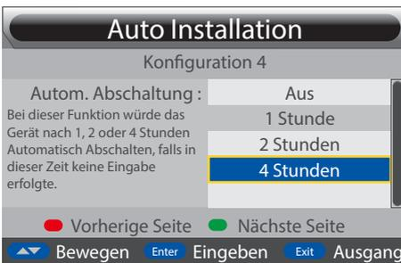
Bild 26 Erstinstallation - automatische Abschaltung einstellen
